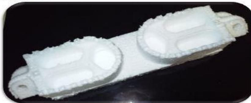
**Conclusion :** Je me suis rendu compte que lors du passage de l'usinage d'une pièce à une autre, l'outil ne dégagait pas assez en hauteur et rentrait en collision avec une pièce. J'ai corrigé le problème en modifiant les points de dégagement des opérations concernées.
